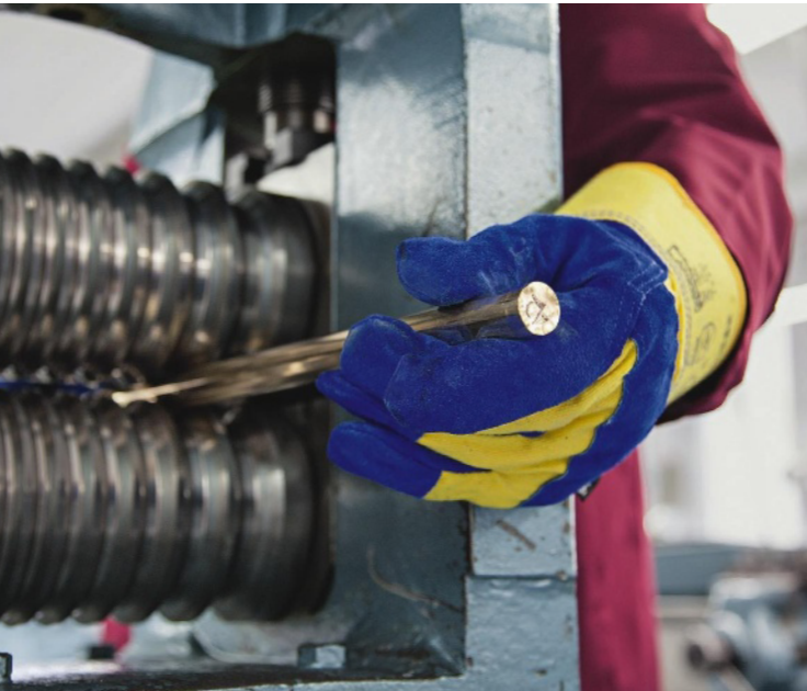
Die Goldstränge (links) werden zu hauchdünnen Fäden; auf einer Spindel werden diese zu Spiralen geformt
